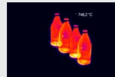
在玻璃瓶生产过程中的热点追踪功能
