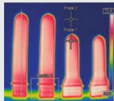
热像仪在PET瓶生产过程中的应用
