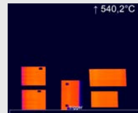
加热区和冷却区之间的玻璃板
